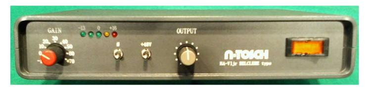
NEVEコンソールV-1のマイクアンプ部分だけを作り変えました。 オリジナルパーツはBELCLEREのトランスと最終部分に使われているチョークコイル のみで他は全て新品のパーツで作り変えてあります。特にゲインスイッチはV1に 使われている物よりも耐久性の高いと言われるエルマのスイッチを採用しました。 電源トランスも十分余裕のある物を使ってとにかく持ち運びが簡単という事を 目標にコンパクトに仕上げました。(発熱が多いので長時間の連続使用の場合は
